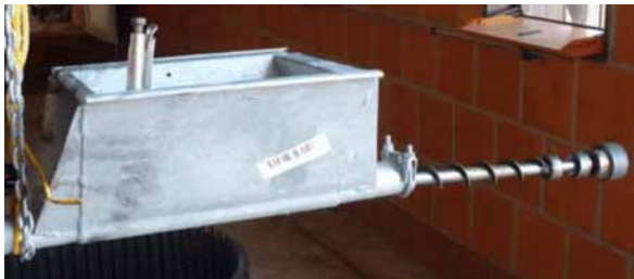
Bild 6-4: Spirale mit Gripzange fixieren
