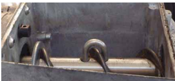
Bild 6-1: Spirale am Antrieb befestigen
