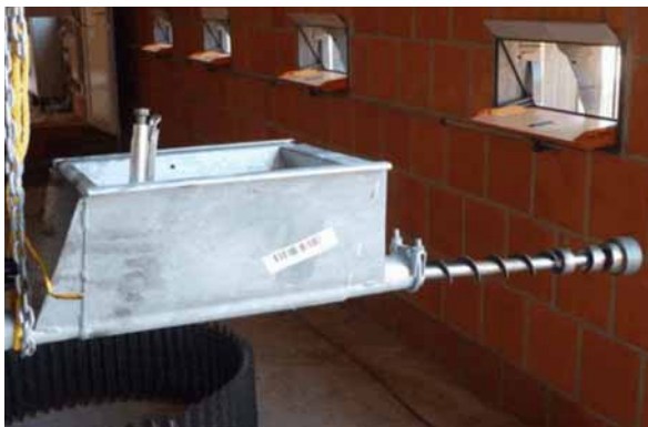
Bild 6-6: Spirale an Spannwelle
